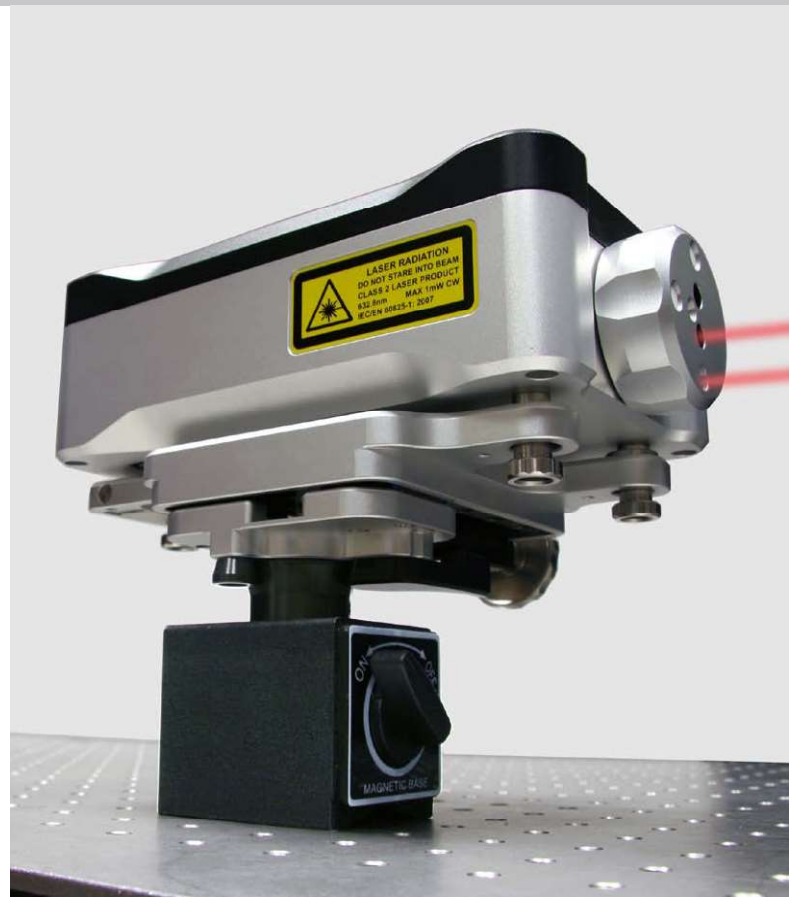
Système à laser XL-80 monté sur socle magnétique
